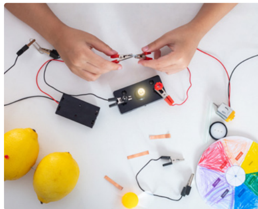
Un copil face un experiment în care sucul din lămâie are rolul unui electrolit
