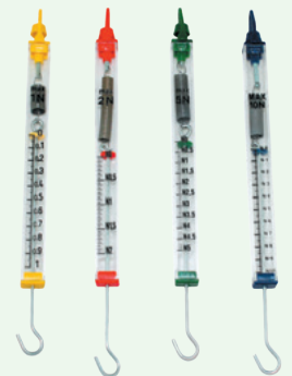
Dinamometre cu resort, ce pot măsura forțe până la 1 N, 2 N, 5 N sau 10 N
