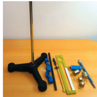
Dinamometre cu resort, ce pot măsura forțe până la 1 N, 2 N, 5 N sau 10 N
