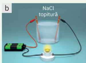
Conductibilitate electrică în topitură
