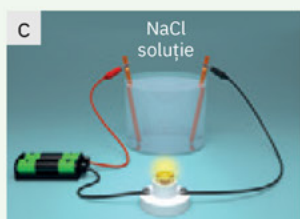
Conductibilitate electrică în soluție
