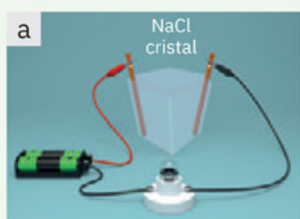
Conductibilitate electrică în cristal
