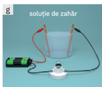
Conductibilitatea electrică a soluției de zahăr
