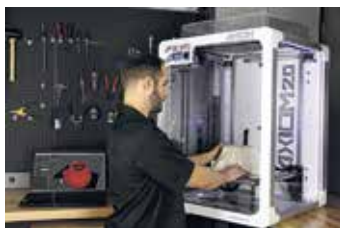
Fig. 2.36. Crearea unei proteze toracice în imprimanta 3D
