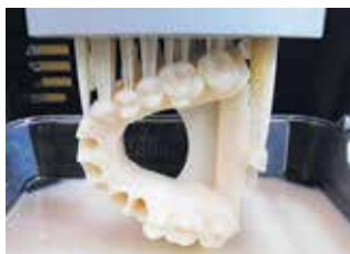
Fig. 2.35. Crearea unei proteze dentare în imprimanta 3D
