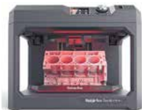
Fig. 2.38. Crearea modelului blocului de cilindri a automobilului în imprimanta 3D
