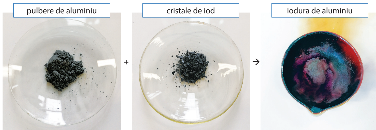
Figura 3 – Reacția aluminiului cu iodul
