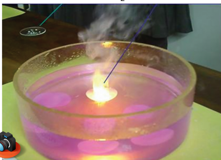
Figura 10 – Reacția sodiului cu apa
