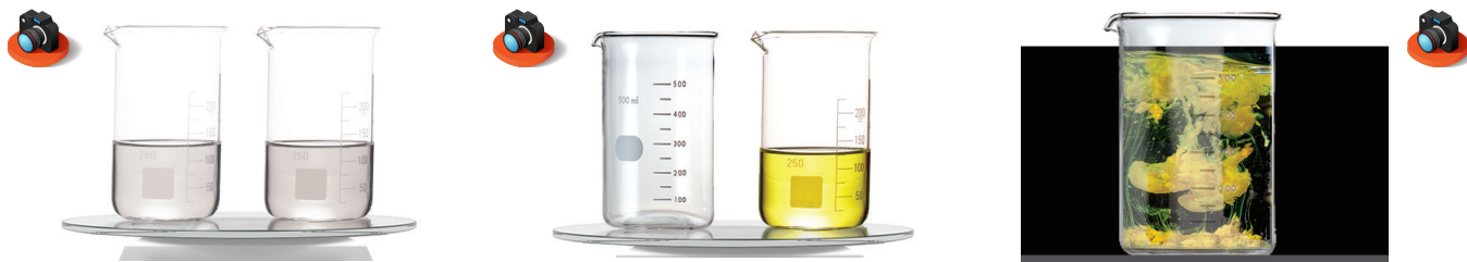
Figura 12 – Soluții de iodură de potasiu și azotat de plumb și amestecul rezultat în urma reacției
