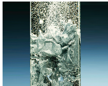
Figura 6 – Reacția zincului cu acidul clorhidric
