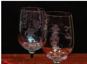
Figura 7 – Gravarea sticlei cu acid fluorhidric
