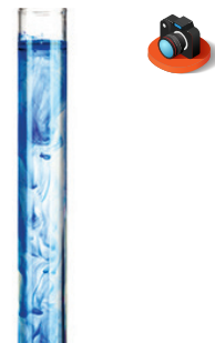
Figura 18 – Precipitarea hidroxidului de cupru
