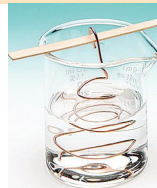
Figura 8 – Sârma de cupru în soluția de azotat de zinc
