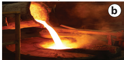
Figura 15 – Furnal pentru obținerea fontei (a), fontă topită (b)
